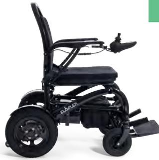
**Poids sans batterie** : 20 kg**Poids avec batterie** : 24 kg**Vitesse max** : 6,5 km/h**Autonomie max** : 30 km + 15 km si 3<sup>ème</sup> batterie**Moteurs** : x 2 (Brushless de 250 W)**Batteries** : x 2 Litium ION 10 AH / 24 V
